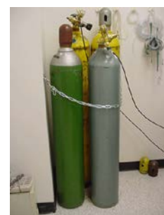
รูปที่ 2.1 ตัวอย่างการวางถังแก๊สที่เหมาะสมในห้องปฏิบัติการ
