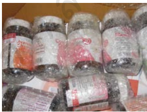
รูปที่ 2.9 ตัวอย่างวัสดุกันกระแทกที่ใช้ในการกันระหว่างขวดสารเคมีขณะเคลื่อนย้าย
